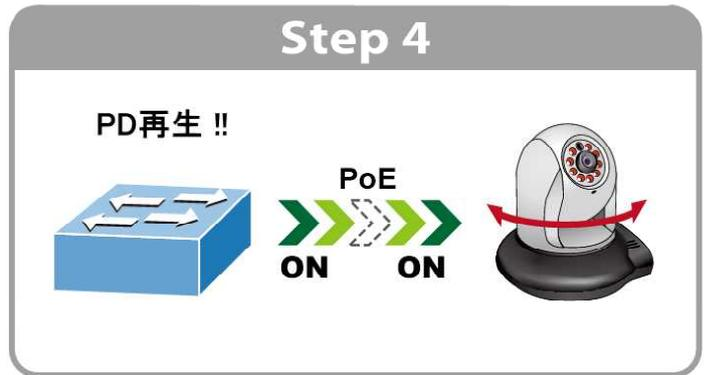
営業時間外のPD(パワーデバイス)電源を、自動的にOFFして節電するマネージ効果！
