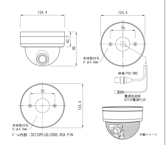
TO POWER BOX: 電源重畳式入力BNCに接続した場合でも、VIDEO BNCから映像信号が出力されます。 DUAL電源供給機能: カメラは電源重畳/別送供給を自動感知して動作しますので、電源重畳電圧が不足する場合 電源入力端子にDC12V電源を供給する事が可能です(保護回路によりカメラを保護します)
