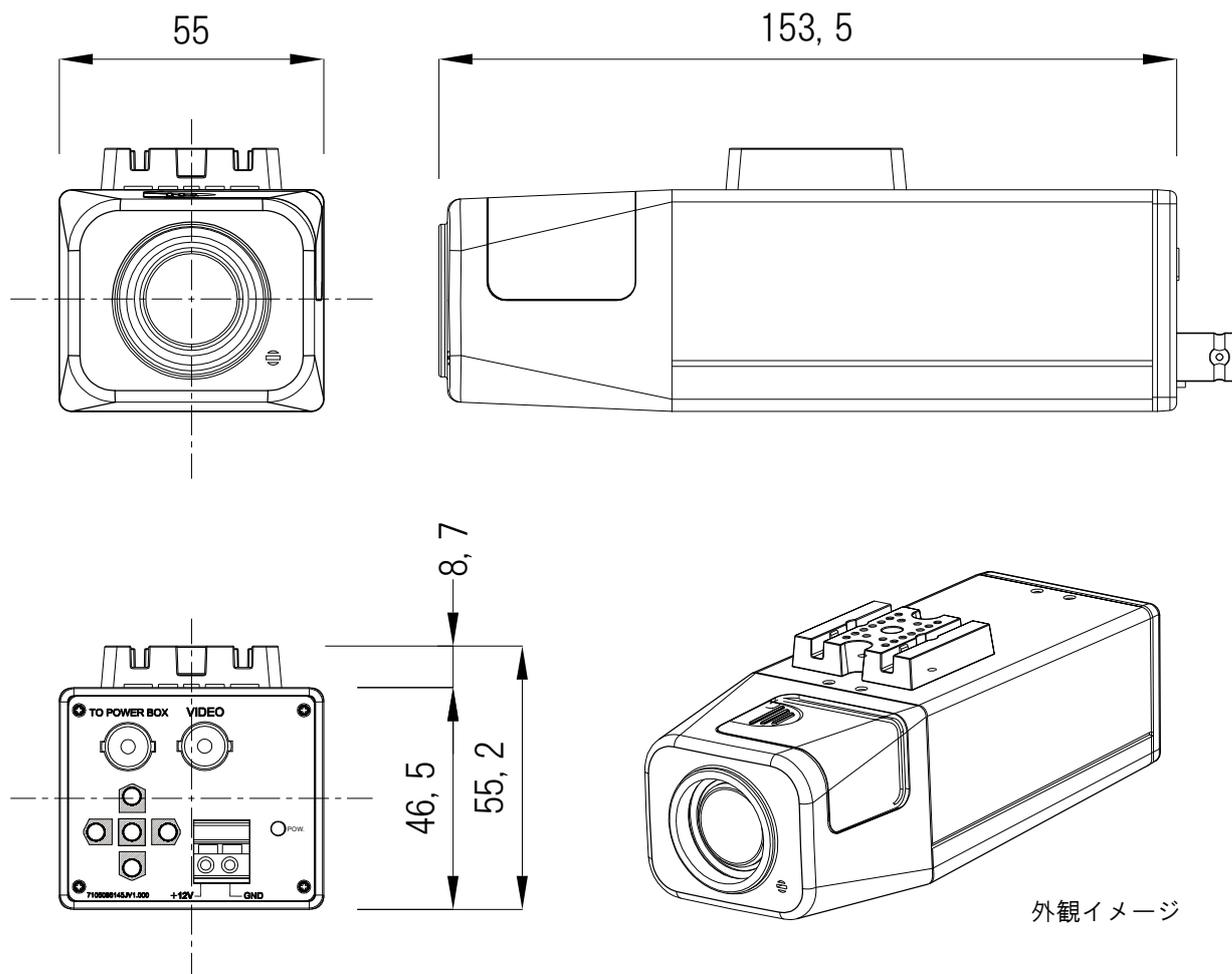
TO POWER BOX: 電源重畳式入力BNCに接続した場合でも、VIDEO BNCから映像信号が出力されます。
